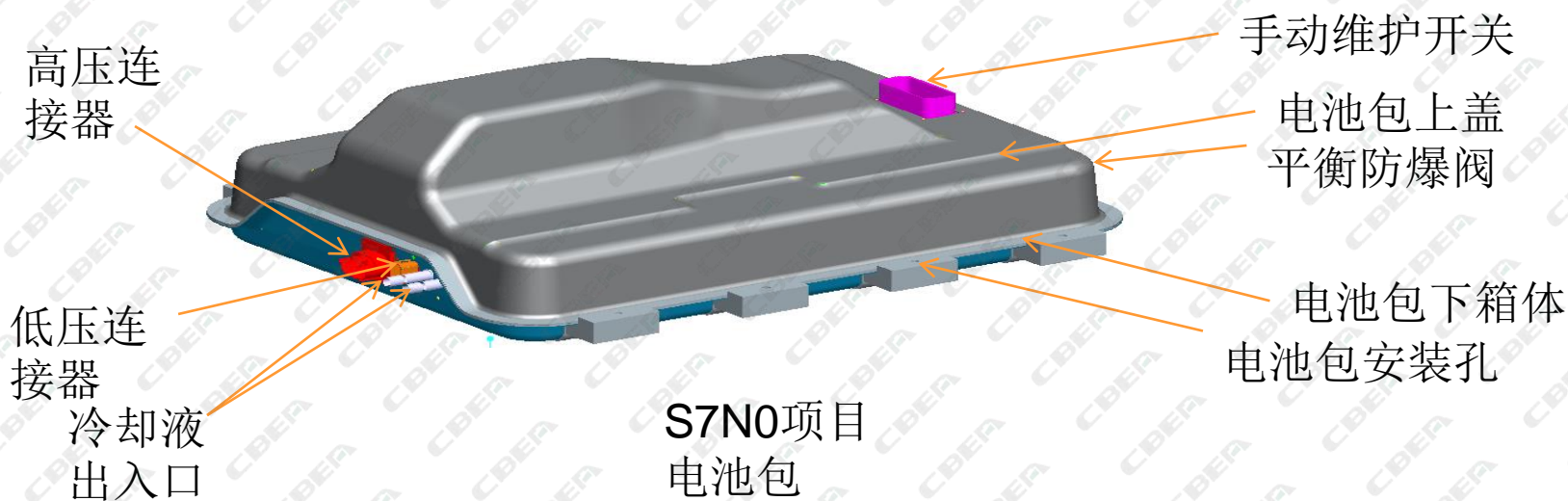
动力电池系统（欣旺达设计、制造）
